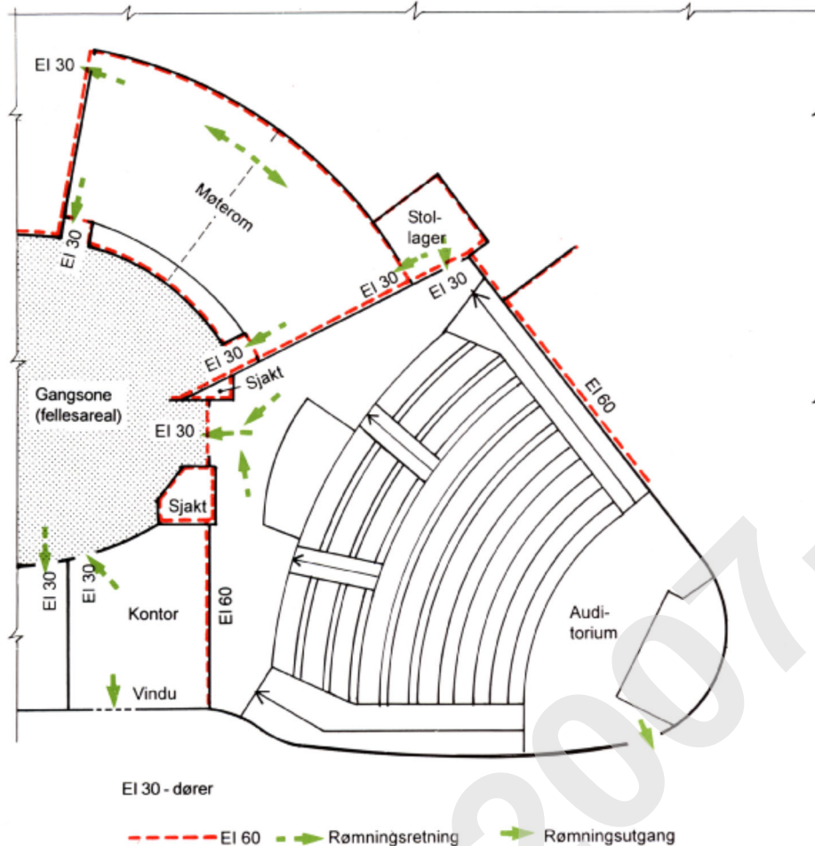
Fig. 13 b Forsamlingslokale. Eksempel på brann teknisk tegning
